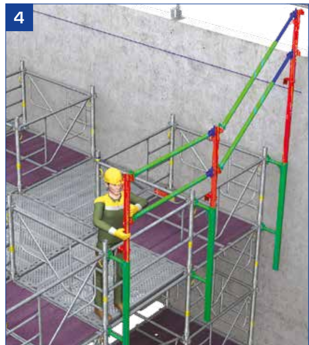
- Die Montage mit dem Anbringen eines Stiels und 2 Streben im benachbarten Rahmenabstand fortsetzen.
