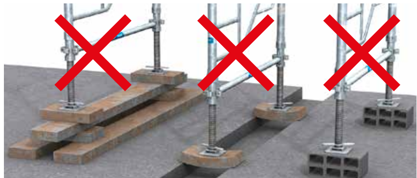
Zu hoch gestapelte Unterlagen Aufbau auf einem Leerraum Aufbau auf einem Hohlkörper
