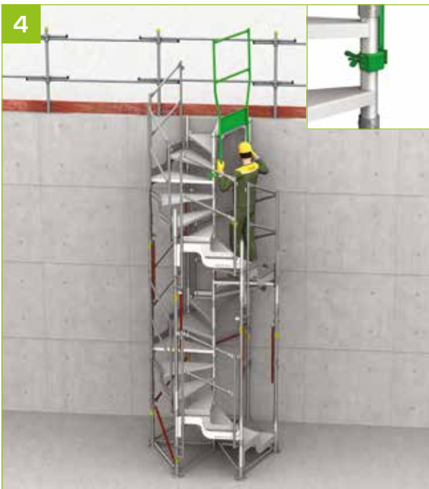
- Pose du garde-corps de fermeture. - Serrer fermement les 2 colliers.
