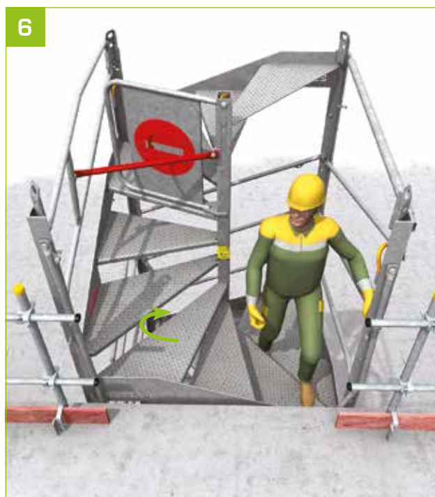
- S'assurer que les amarrages sont installés avant le décrochage des élingues. - Basculement des garde-corps pour permettre la sortie au niveau souhaité.
