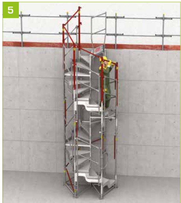
- Pose de 5 poteaux rouges de fermeture. - En redescendant, mise en place de toutes les 3 e lisses rouges (sauf entrées) et du garde-corps d'entrée B. Mettre la 3 e lisse rouge jusqu'en haut.
