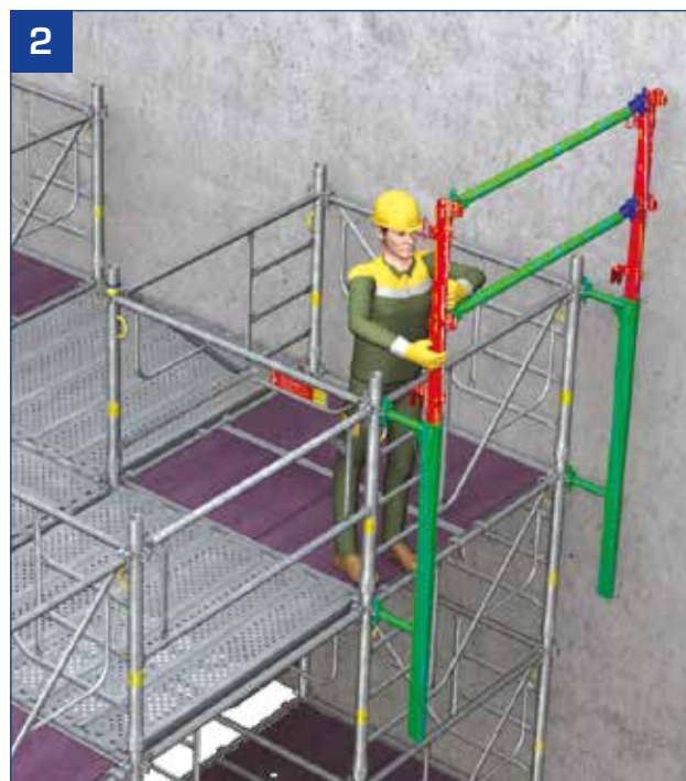
- Pose des 2 lisses extensibles du garde-corps de coffrage MDS sur les montants du garde-corps de coffrage MDS.
