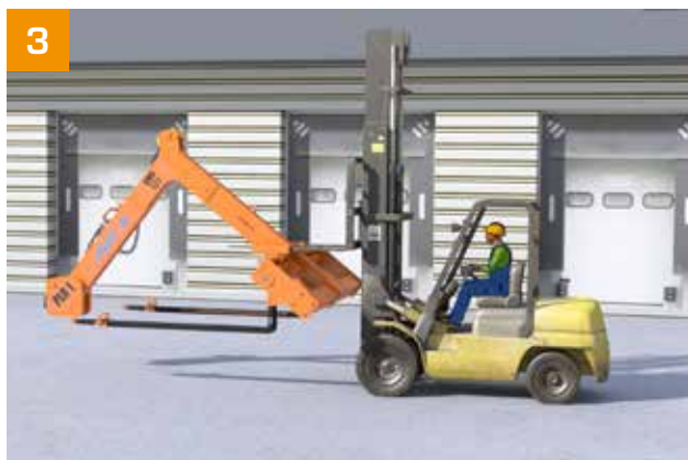
3 Première méthode de chargement : par les fourreaux...
