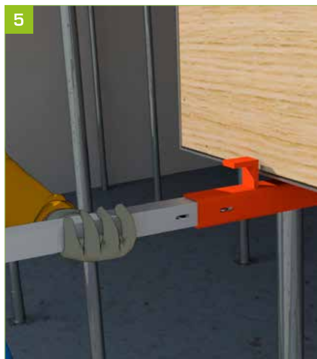
5 - Die Pfosten in den AlphiSafe-Adapttern für MaxiDalle einrasten lassen.
