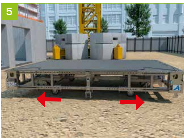
5 - Die Abmessung je nach Bedarf (genaue Vorgehensweise auf der nächsten Seite) einstellen.
