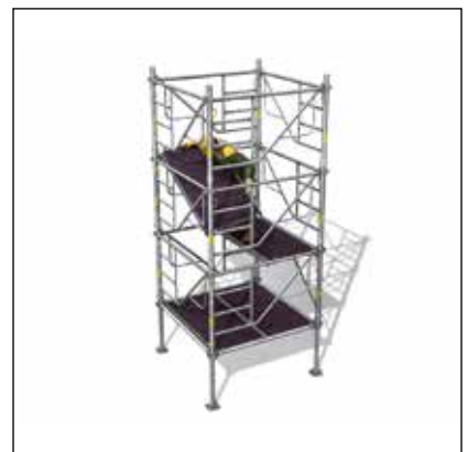
- Die Durchstiegs elements auf ihre endgültige Position hochheben, so dass 2m Abstand zwischen den Ebenen bleibt. - Versetzen des ersten Durchstiegs elements.
