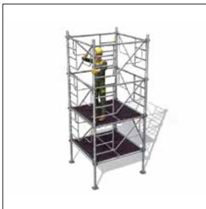
- Einbau der dritten Ebene.
