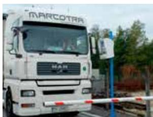
Les camions sont arrêtés à l'entrée du pôle et pesés. Le chauffeur saisit sur écran l'immatriculation sans sortir de la cabine. Une fois déchargé, le véhicule est à nouveau pesé à la sortie.
