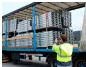
Le camion est débâché et le matériel désanglé. Une série de photos du véhicule et du matériel est réalisée.
