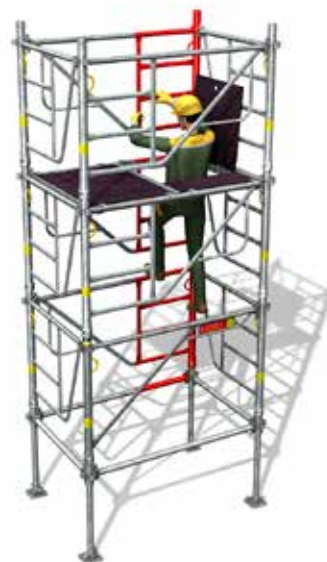
- Le premier niveau de plancher peut être enlevé. Accès au niveau supérieur par l'échelle intégrée.
