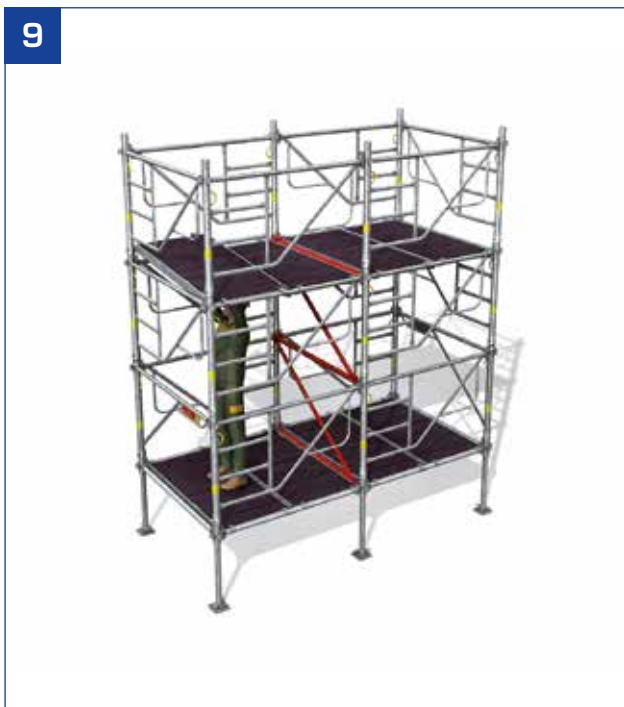
- Déplacement du 4 e plancher à trappe depuis le niveau inférieur.
