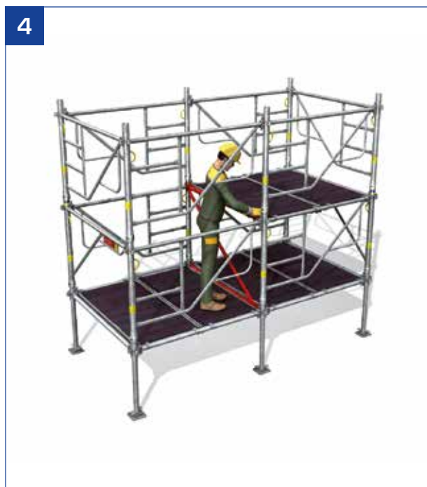
- Contreventement impératif avec une moise et une diagonale.
