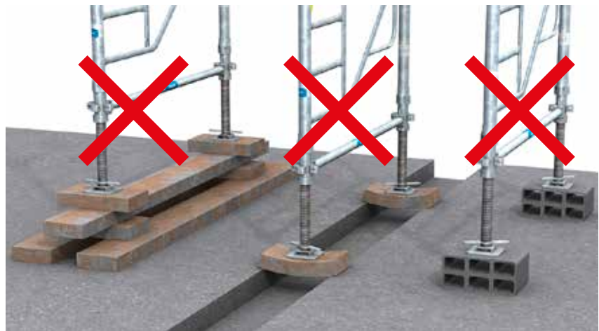
Empilage excessif de cales
