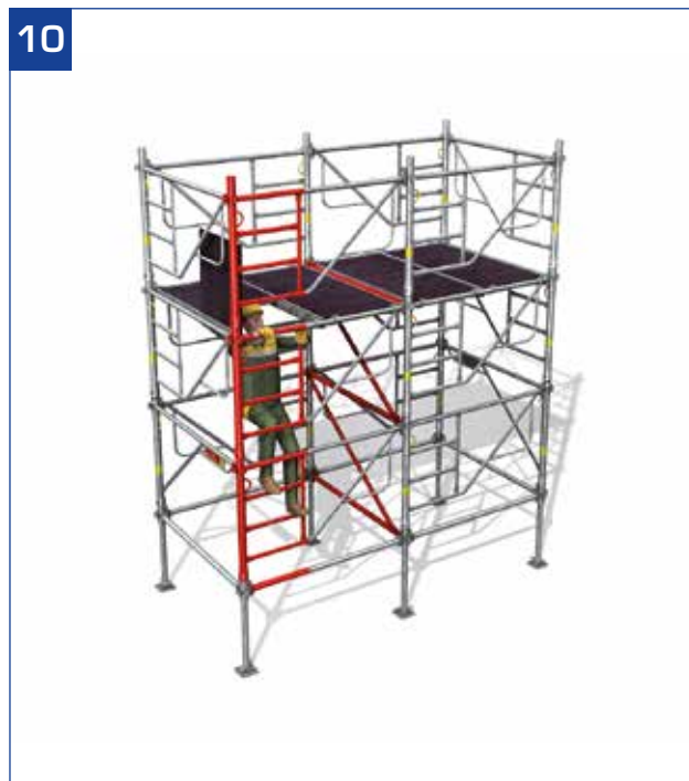
- Le premier niveau de plancher peut être enlevé. Accès au niveau supérieur par l'échelle intégrée.
