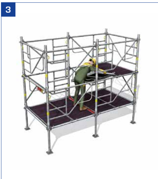
- Monter un niveau de plancher en position provisoire. - Pose d'un 2 e niveau de plancher.
