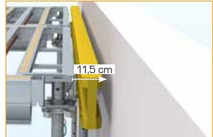
À partir de 11,5 cm de vide, il est possible d'insérer une poutrelle H20 sur des étais munis de fourches.
