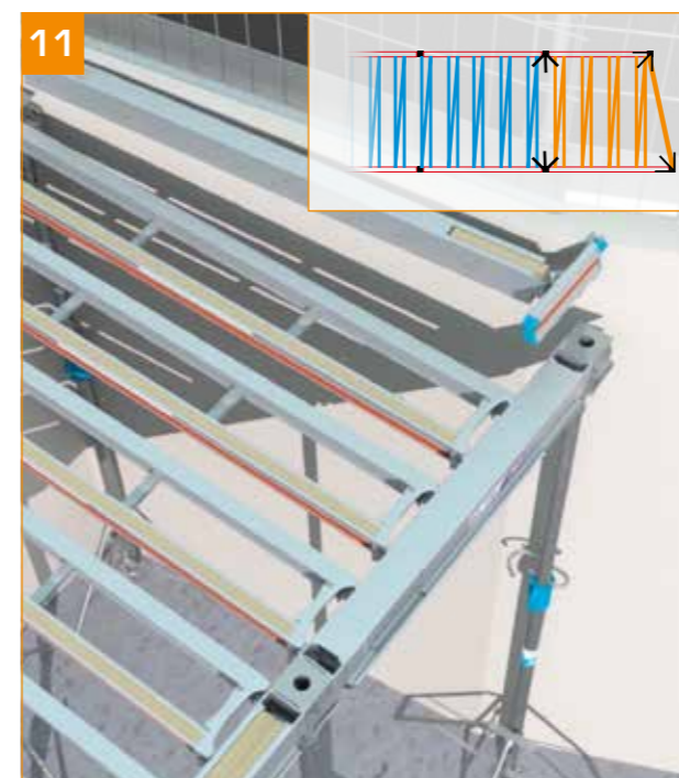
11 - Mettre en place la poutrelle secondaire angulaire.
